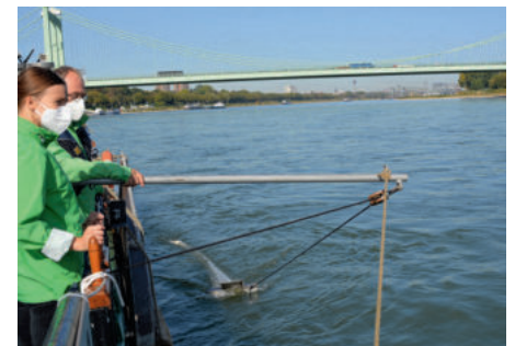
Erste Stichprobe: Hinter der Rodenkirchener Brücke angeln Greenpeace-Chemiker Manfred Santen und Assistentin Leah Petersen mit dem „Manta-Trawler“ nach Mikroplastik.
